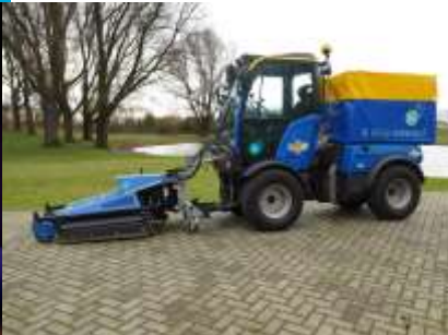
Dual Fuel Tractor en Holder; 60-80% waterstof bijmengen mogelijk
